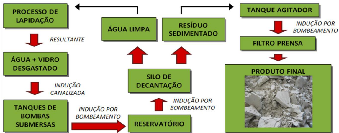
2.1 - Fluxograma do processo completo de obtenção do resíduo de lapidação de vidro sodo-cálcico utilizado neste estudo.
