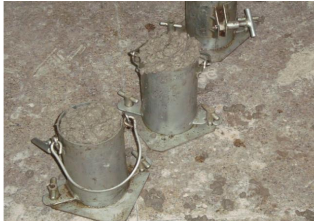
Figura 3.9 – Início da preparação dos corpos de prova
