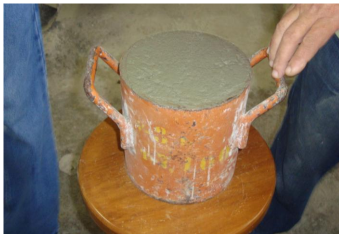
Figura 3.14 - Recipiente utilizado para o ensaio de massa específica após rasamento, pronto para ser pesado em balança com tara preparada
