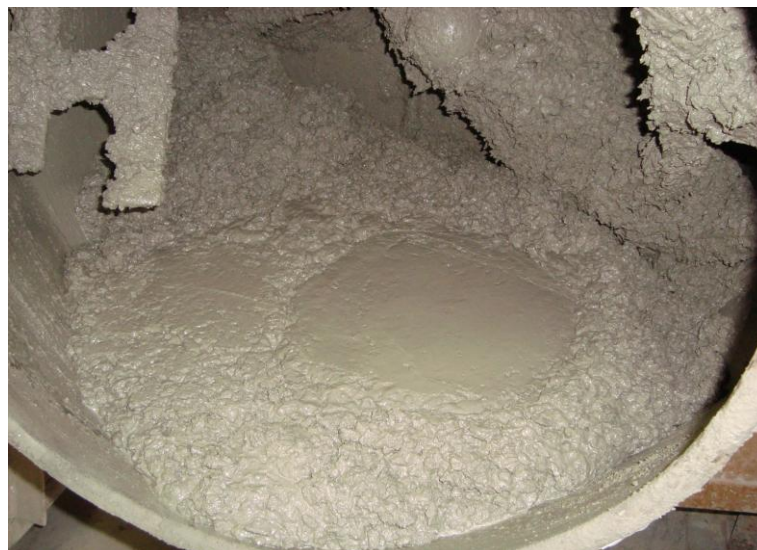
Figura 3.8 - O aspecto liso da massa de concreto de traço referência após homogeneização em betoneira demonstra boa trabalhabilidade
