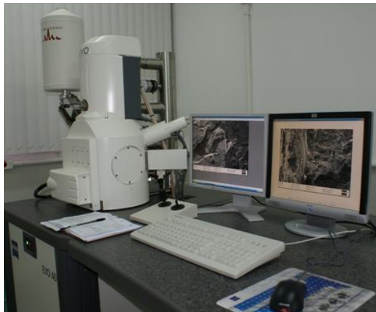
Figura 3.16 – MEV equipado com EDS utilizado para ampliação e análise microestrutural das amostras das pastas cimentícias e dos concretos produzidos em fase endurecida
