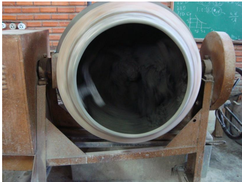
Figura 3.7 - Betoneira de eixo inclinado com capacidade de 350 litros utilizada para homogeneizar as misturas de cada traço dos concretos
