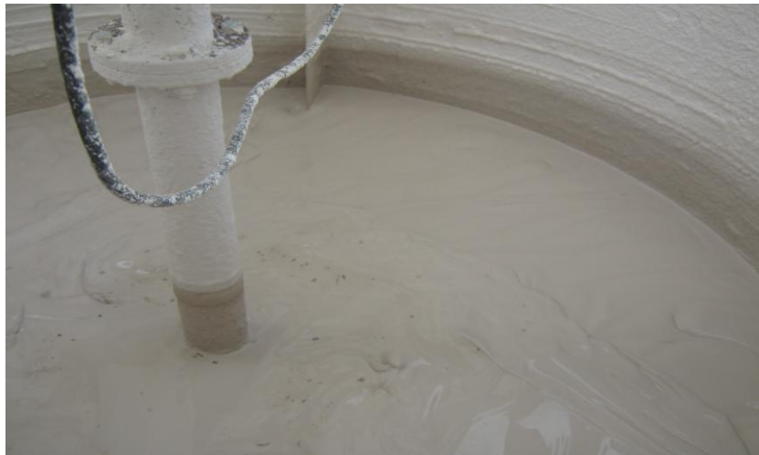
Figura 2.6 - Resíduo proveniente do silo de decantação depositado no tanque agitador, para evitar ressecamento da lama
