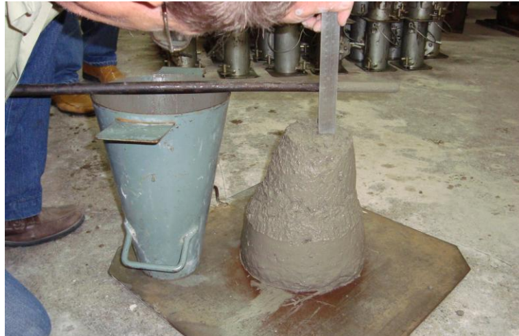
Figura 3.13 – Aparência do concreto referência no momento da aferição da consistência
