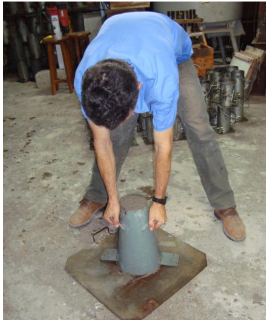
Figura 3.12 - Retirada do tronco de cone para ensaio de consistência
