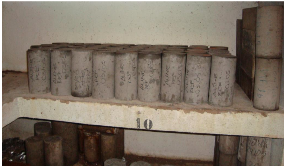
Figura 3.11 - Corpos de prova armazenados em câmara úmida para processo de cura uniforme
