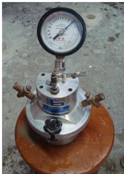
Figura 3.15 - Equipamento utilizado para realizar o ensaio de teor de ar incorporado
