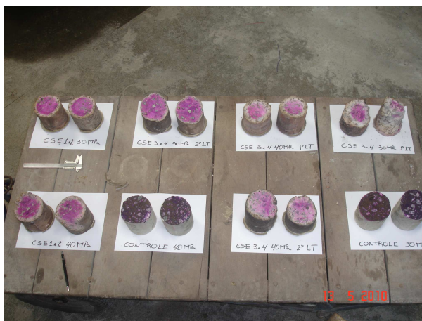
Figura 3.41. Corpos de prova para medição da profundidade de carbonatação
