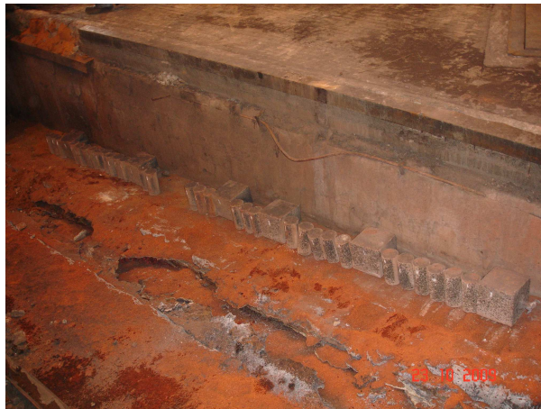
Figura 3.58. Corpos de prova posicionados internamente na lateral do início do canal secundário de escória 2 do alto forno 3
