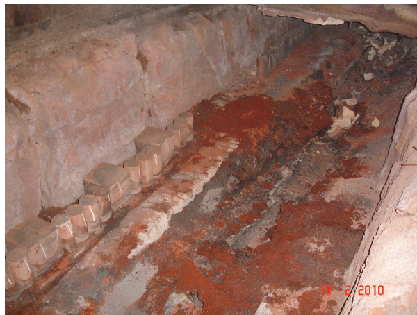
Figura 3.61. Corpos de prova posicionados internamente na lateral do início do canal secundário de escória 3 do alto forno 3
