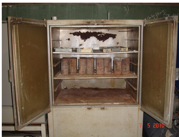
Figura 3.30. Secagem das amostras em estufa (105 +/- 5°C) por 72 horas
