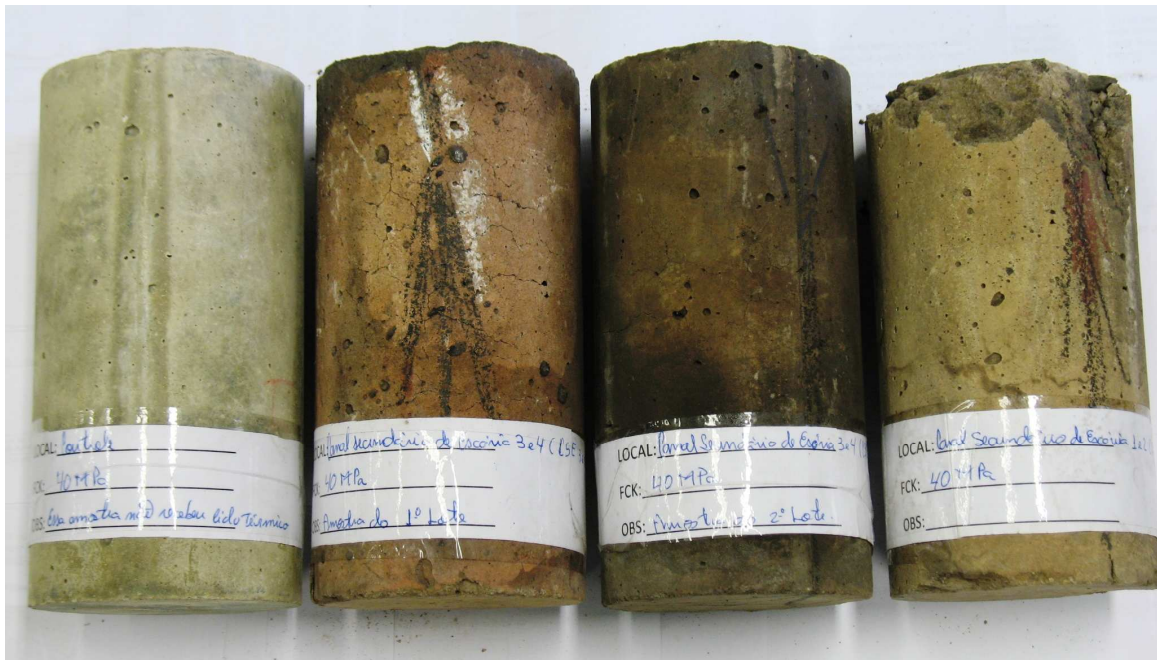
Figura 3.51. Aspecto geral dos corpos de prova de concreto C40. À esquerda a amostra de referência e à direita três amostras submetidas aos ciclos de radiação térmica
