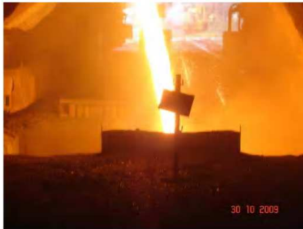
Figura 3.8. Fosso da balança de pesagem de gusa (material sendo vertido)
