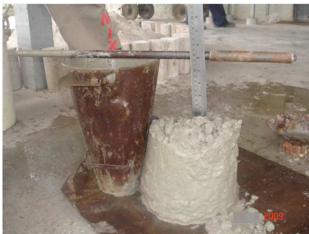
Figura 3.24. Verificação do abatimento
