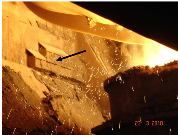
Figura 3.69. Corpos de prova posicionados (indicados na seta) na lateral do pilar central de sustentação do convertedor 2 na Aciaria – momento do vazamento do convertedor
