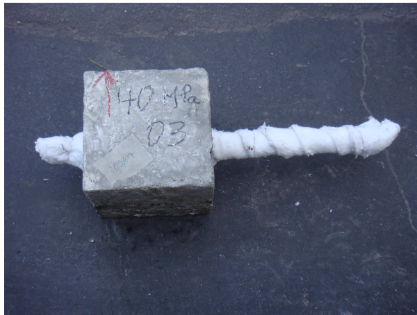
Figura 3.19. Proteção das barras com isolamento térmico
