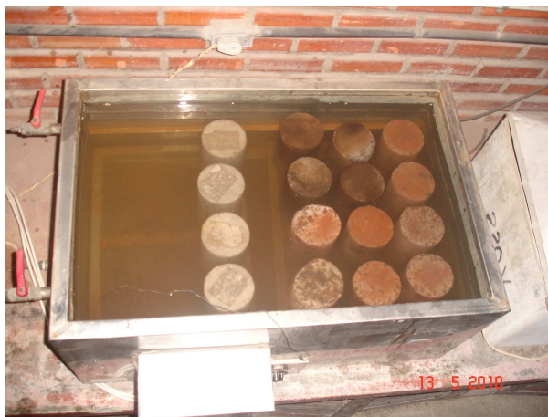
Figura 3.32. Saturação das amostras com ebulição por período de 5 horas
