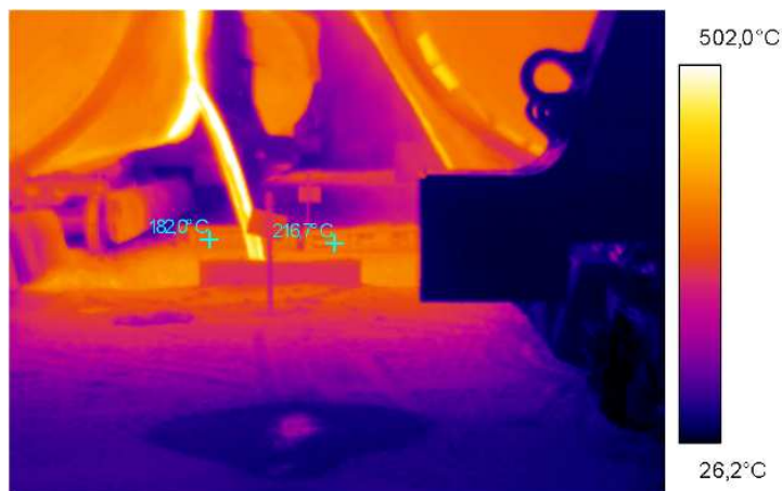
Figura 3.9. Termografia mostrando temperaturas entre 182°C e 216°C na borda do fosso da balança de pesagem de gusa
