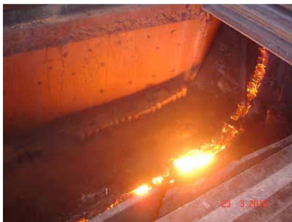
Figura 3.66. Corpos de prova posicionados internamente na lateral do final do canal secundário de escória 4 do alto forno 3 – detalhe da corrida de escória no leito de refratários
