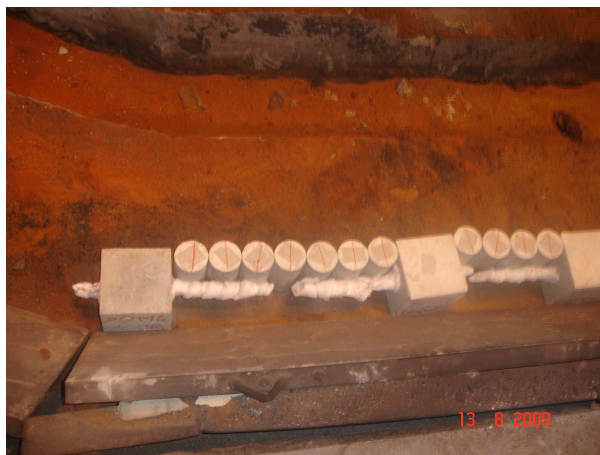
Figura 3.20. Arranjo: corpos de prova cilíndricos protegem a armadura dos corpos de prova prismáticos evitando a radiação térmica direta sobre as mesmas
