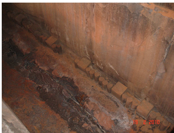
Figura 3.65. Corpos de prova posicionados internamente na lateral do final do canal secundário de escória 3 do alto forno 3
