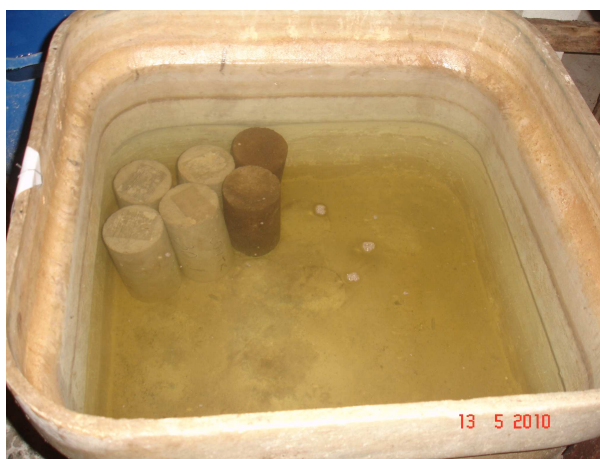
Figura 3.31. Saturação das amostras em água (23 +/- 2°C) por 72 horas
