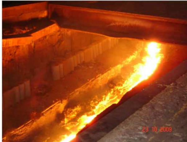
Figura 3.62. Corpos de prova posicionados internamente na lateral do início do canal secundário de escória 4 do alto forno 3 – detalhe da corrida de escória no leito de refratários
