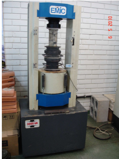
Figura 3.26. Equipamento para ensaio de resistência a compressão e módulo de elasticidade – EMIC modelo SSH3
