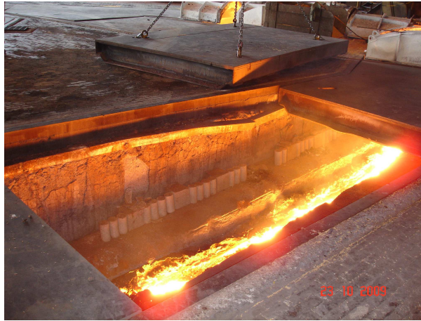
Figura 3.54. Canal secundário de escória 4 – seção com pequena altura no início do canal – Detalhe dos corpos de prova dispostos na lateral do canal.
