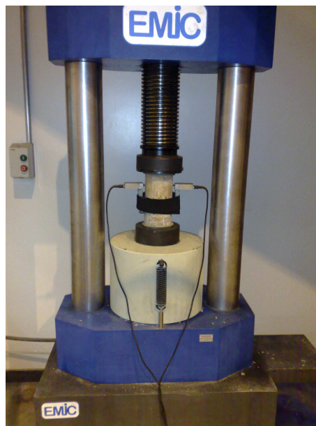
Figura 3.28. Ensaio de verificação do módulo de elasticidade – Equipamento Prensa EMIC modelo SSH300
