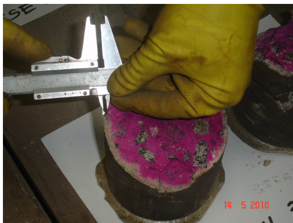
Figura 3.40. Medição da profundidade de carbonatação
