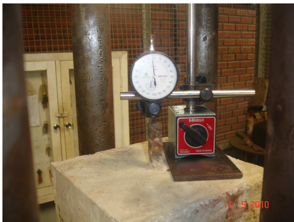
Figura 3.36. Relógio comparador com extensômetro de precisão (1 \mu m) marca Mitutoyo
