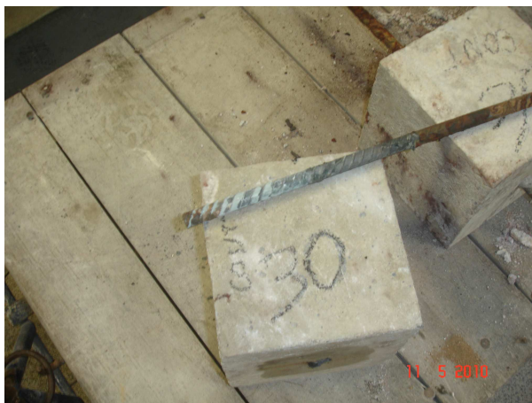
Figura 3.39. Barra de armadura totalmente extraída do corpo de prova
