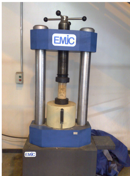
Figura 3.27. Equipamento para ensaio de resistência a compressão e módulo de elasticidade – EMIC modelo SSH300
