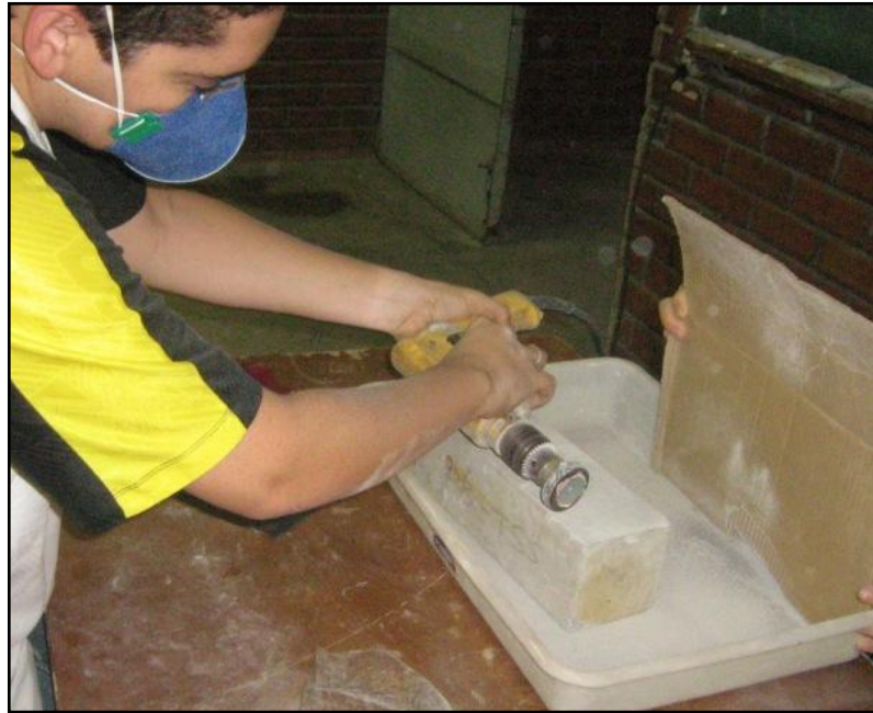
Figura 4.12: raspagem do concreto para retirada de amostra superficial.
