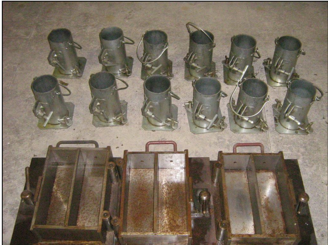
Figura 4.10: formas metálicas para moldagem dos corpos de prova.
