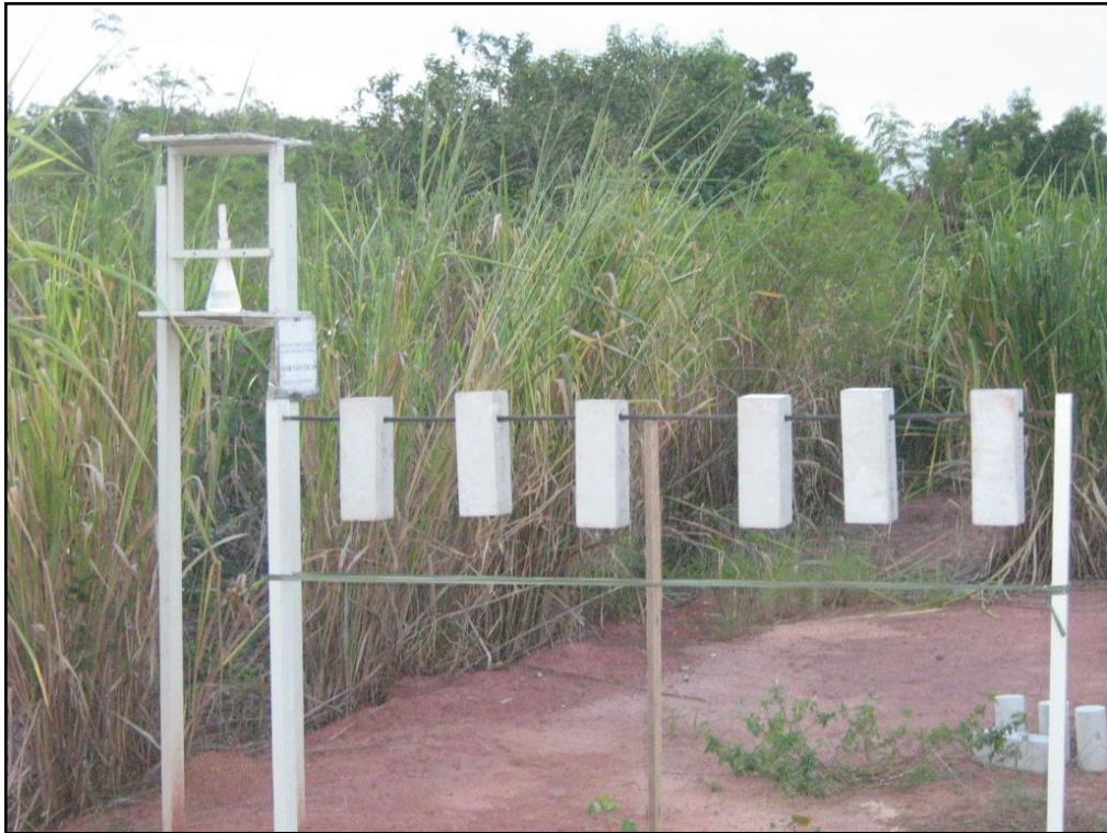
Figura 4.11: exposição dos corpos de prova de concreto, próximo ao aparato de vela úmida.
