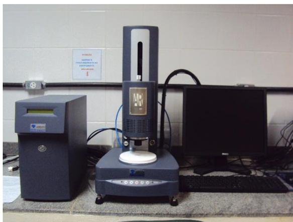
Figura 6 – Reômetro rotacional modelo AR 2000ex, fabricante *TA Instruments*.
