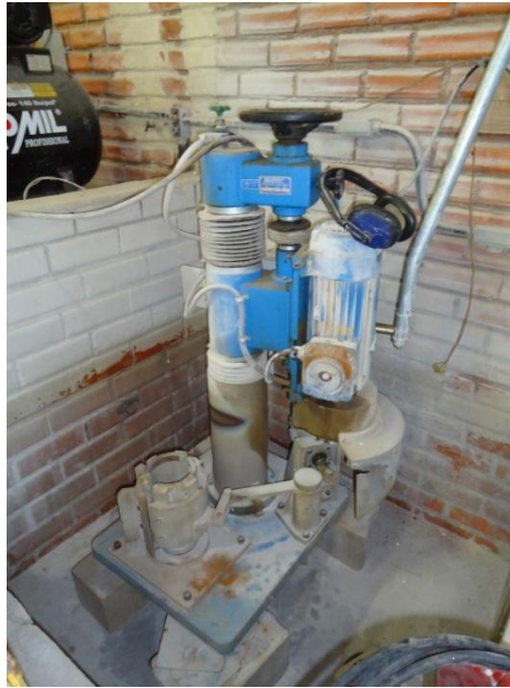
Figura 36 - Retífica utilizada para regularização dos corpos de prova
