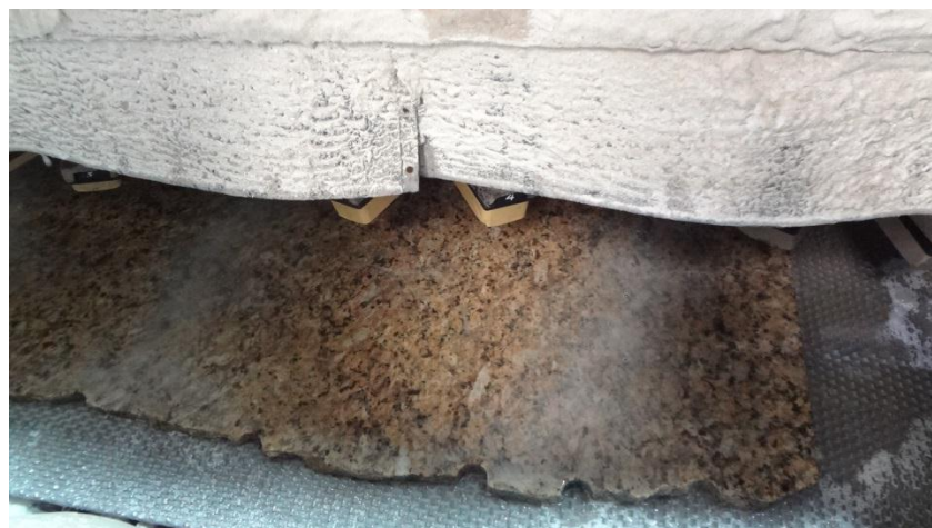
Figura 7 - Processo de polimento das chapas
