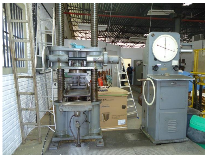
Figura 35 - Prensa utilizada para o ensaio de resistência à compressão axial
