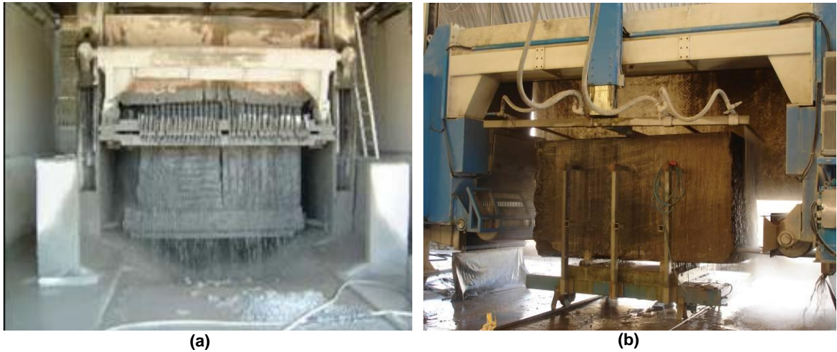
Figura 2 - (a) Tear tradicional e (b) tear multifios
