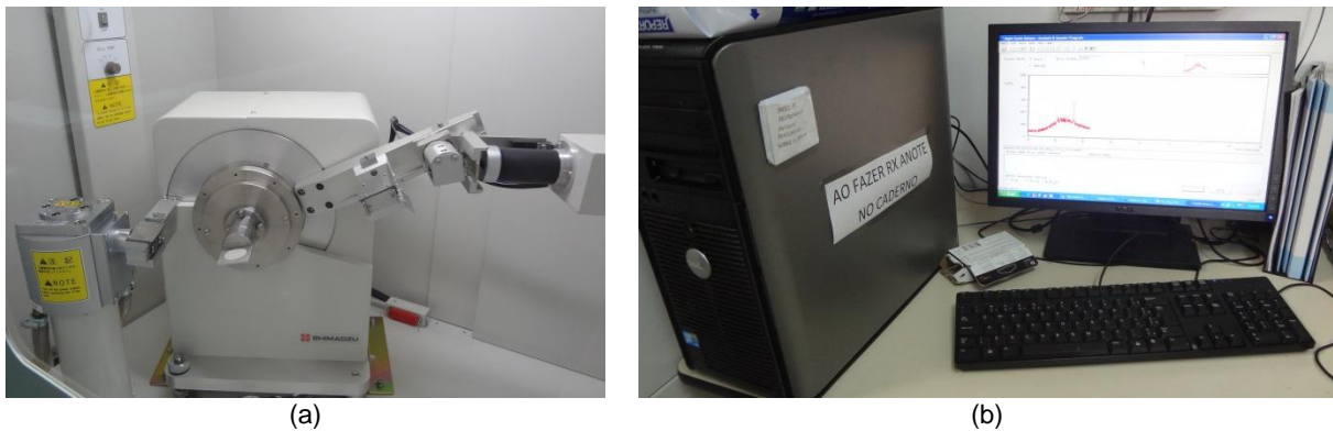
Figura 28 - Ensaio de difração de raios X (a) difratômetro e (b) computador com software.
