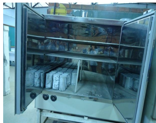
Figura 41 - Corpos de prova em estufa ventilada
