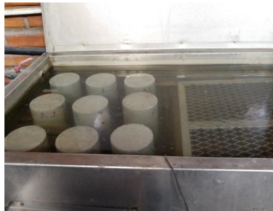
Figura 37 - Ensaio de absorção de água por imersão
