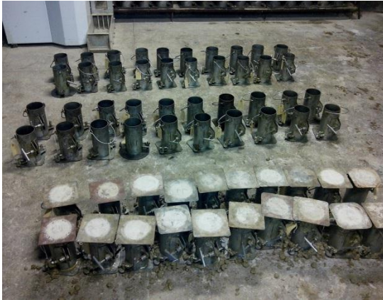
Figura 32 - Concretos moldados e cobertos nas formas cilíndricas
