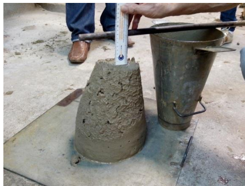
Figura 34 - Ensaio de consistência pelo abatimento do tronco de cone
