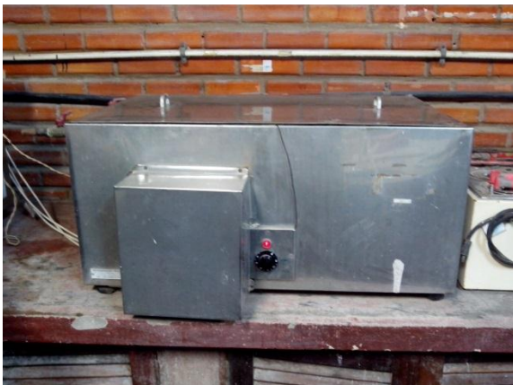
Figura 37 - Ensaio de absorção de água por imersão
