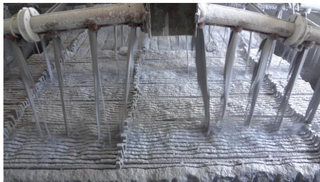
Figura 3 - Detalhe da aspersão da polpa abrasiva sobre o bloco durante o corte em um tear tradicional
