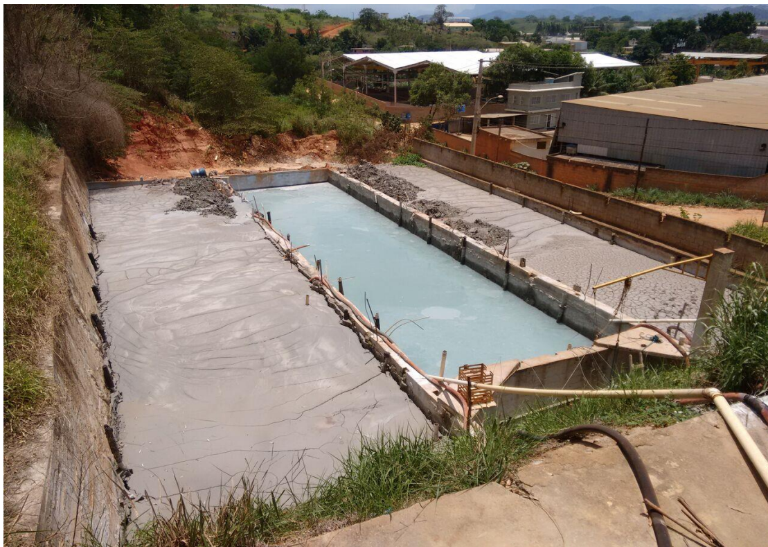
Figura 2.9 – RBRO em forma de lama no tanque de decantação
