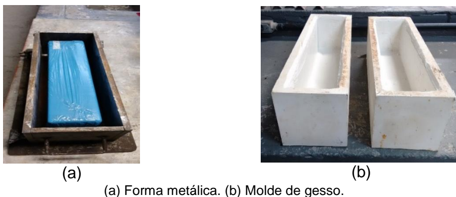
Figura 3.6 – Confeção da forma para o processo de tratamento térmico do RBRO.
