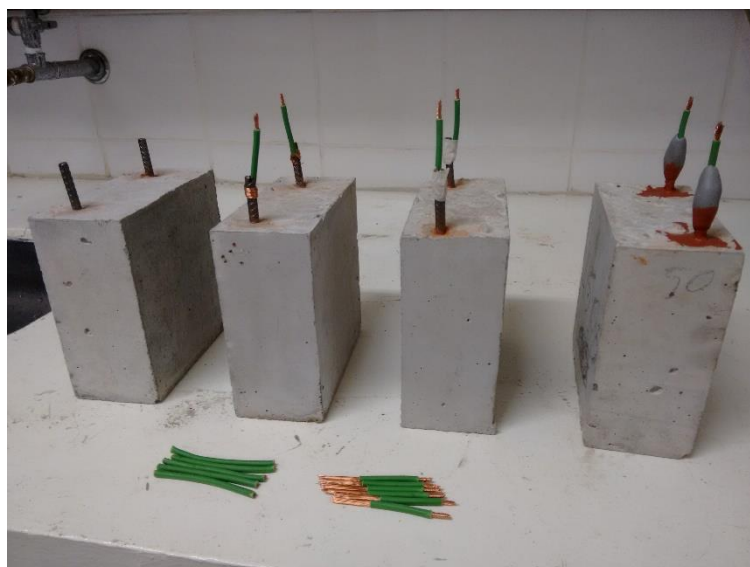
Figura 3.13 – Etapas do processo de proteção da armadura exposta nos corpos de prova.
