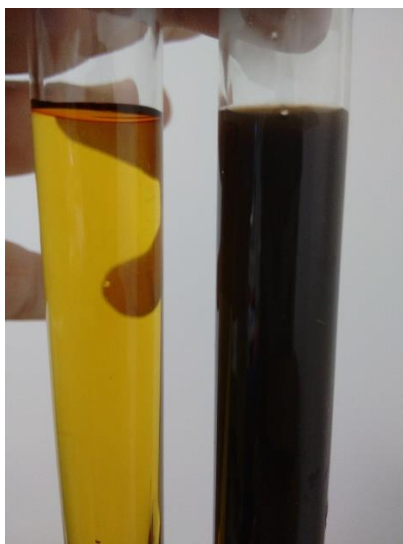
Figura 3.2 - Ensaio de determinação de matéria orgânica no agregado miúdo
