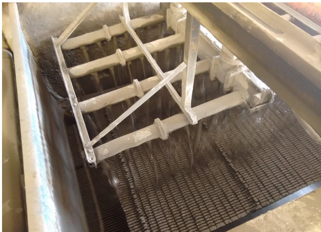
Figura 2.8 – Desdobramento por teares convencionais com polpa abrasiva
