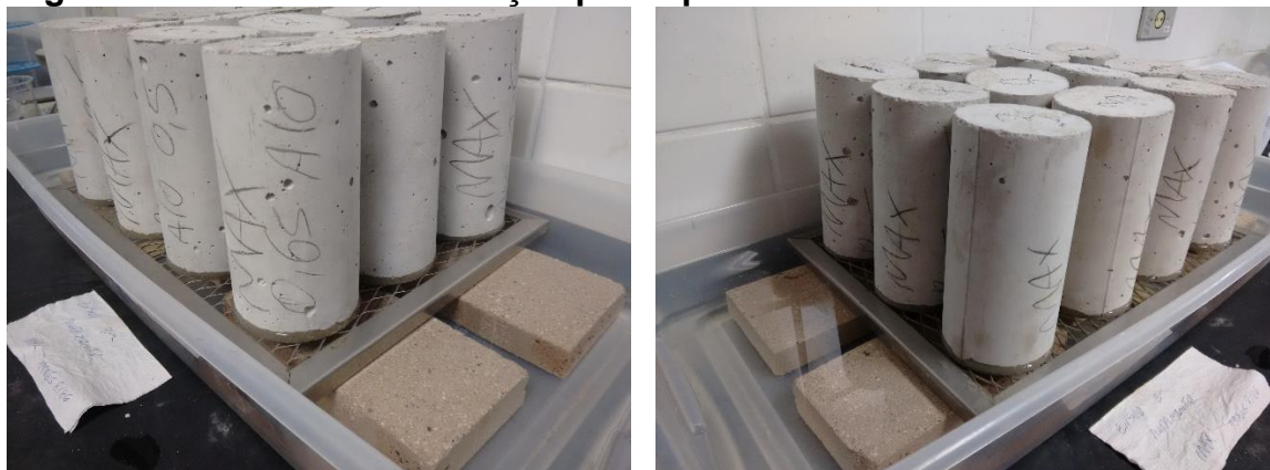
Figura 3.10 - Ensaio de absorção por capilaridade
