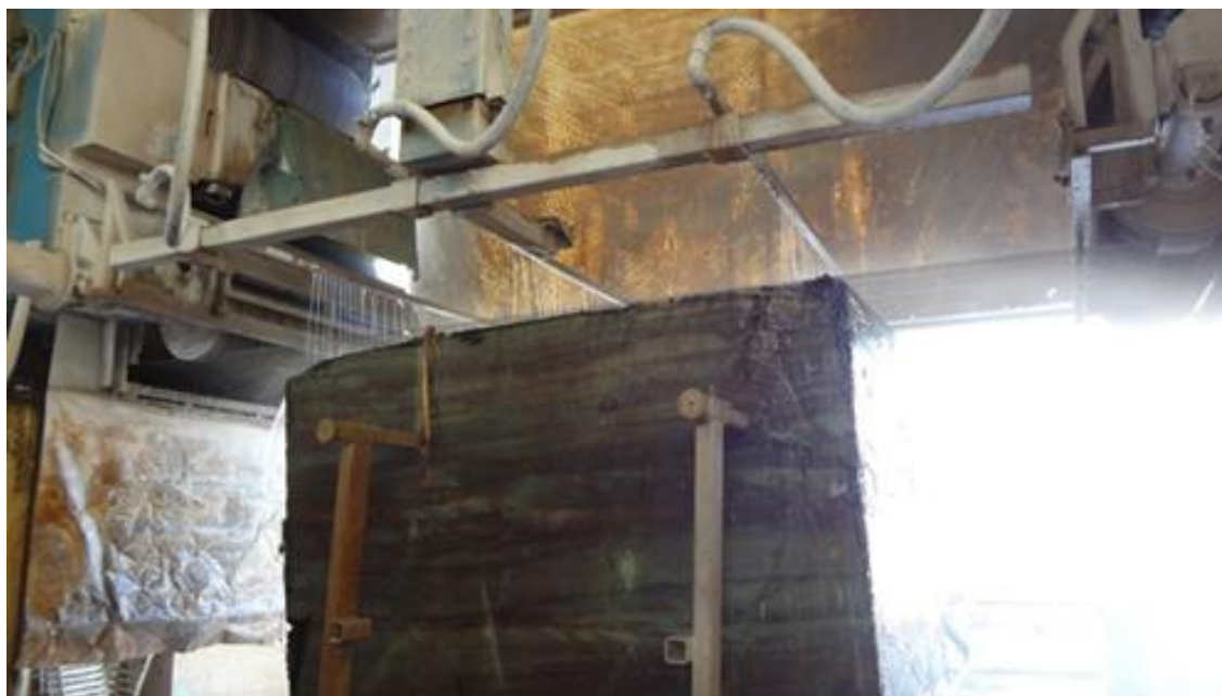
Figura 2.7 - Desdobramento por teares com fio diamantado
