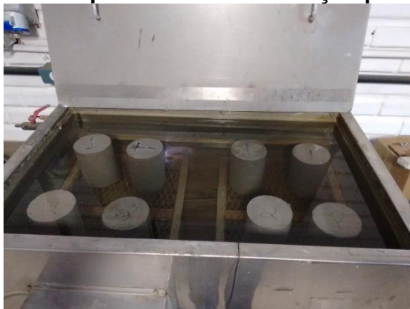
Figura 3.9 – Equipamento para ensaio de absorção por imersão e fervura.
