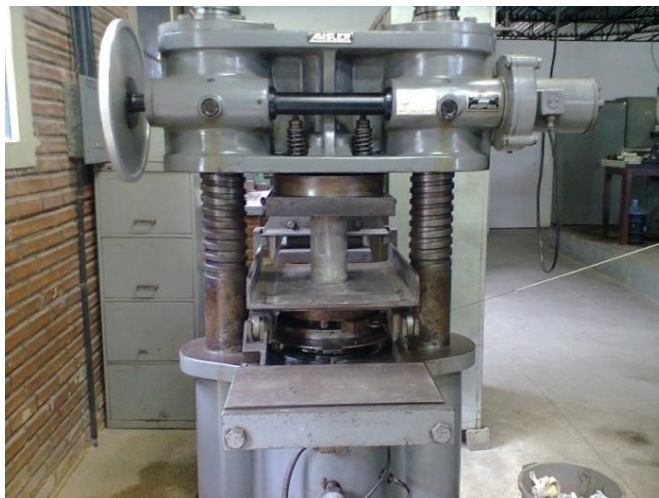
Figura 3.17 - Prensa utilizada no ensaio de resistência à compressão
