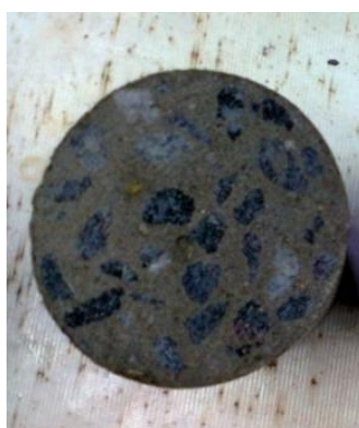
Figura 4.13 - Corpo de prova do concreto mostrando a fase agregado e meio ligante
