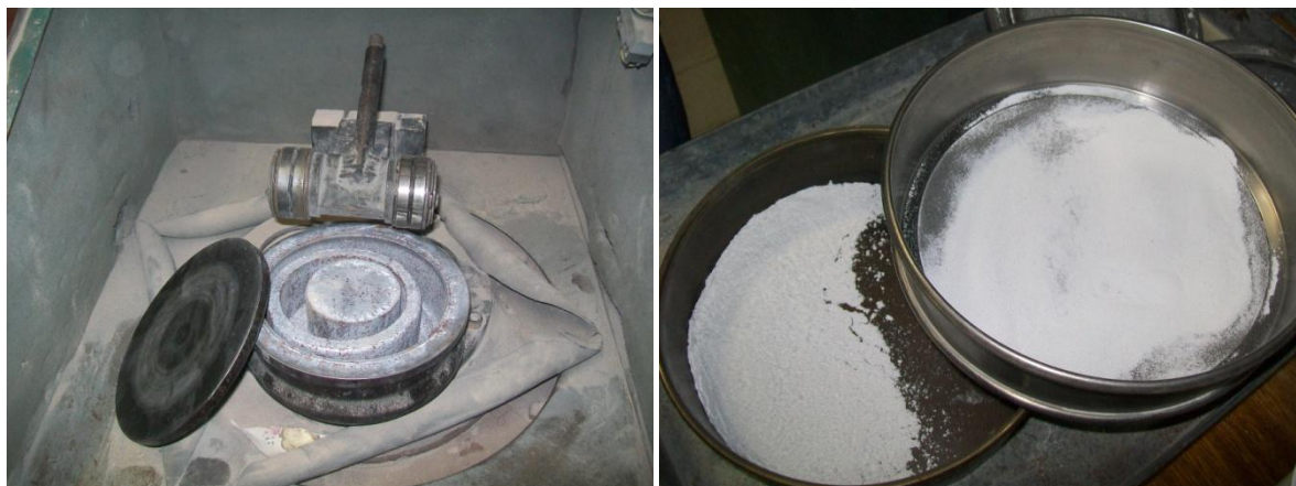
Figura 3.10 - Moinho de argolas e resíduo de vidro laminado após processo de moagem
