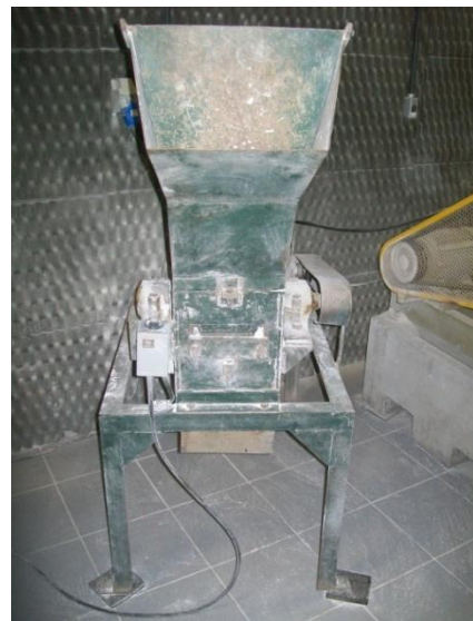
Figura 3.8 - Equipamento utilizado para destorrear o RVL
