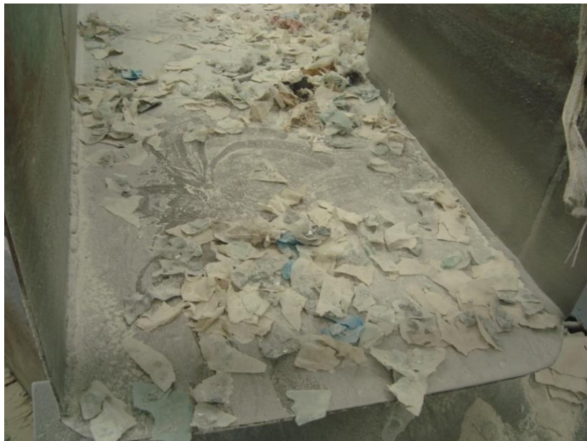
Figura 2.3 - Lâminas de PVB separadas da película de vidro
