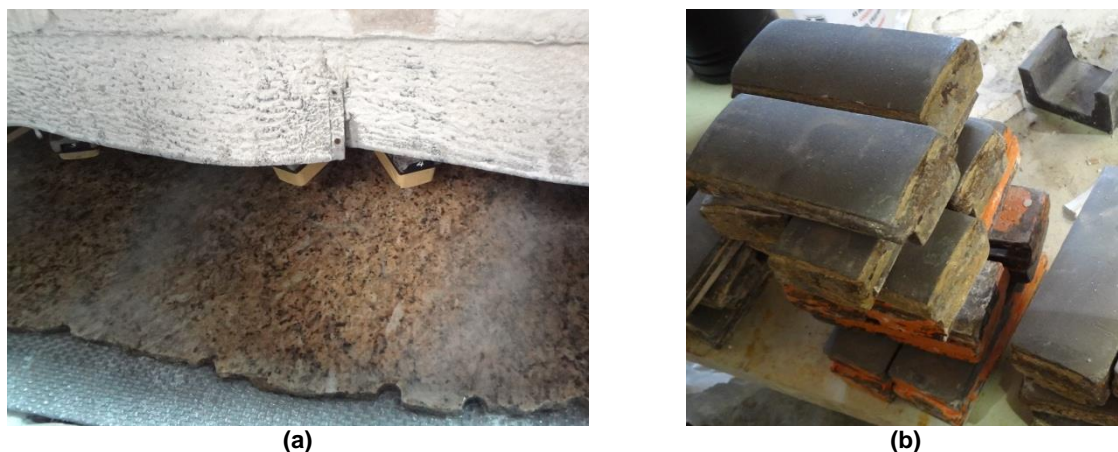
Figura 10: (a) Polimento de chapa e (b) detalhe de sapatas já utilizadas e suporte para encaixe na politriz.
