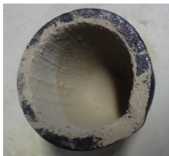
Figura 35: Cadinho de grafite com tinta refratária.
