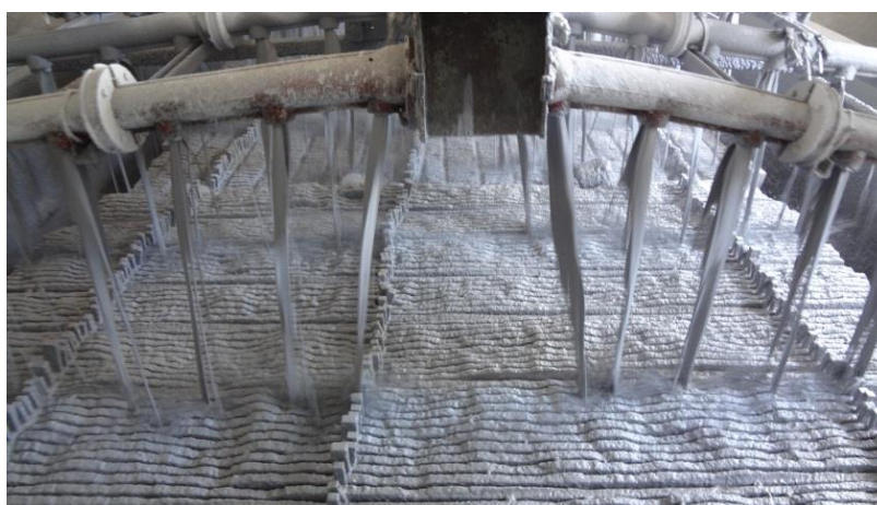
Figura 7: Detalhe da aspersão de polpa abrasiva sobre o bloco durante o corte em um tear tradicional.
