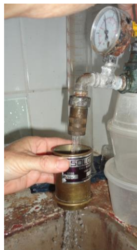
Figura 30: Ensaio de finura por meio da (a) peneira nº 200, (b) peneira nº 325 e pelo (b) método da permeabilidade de Blaine.
