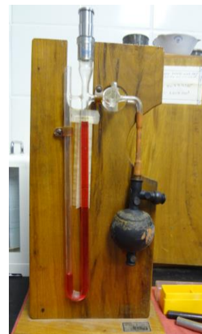
Figura 30: Ensaio de finura por meio da (a) peneira nº 200, (b) peneira nº 325 e pelo (b) método da permeabilidade de Blaine.
