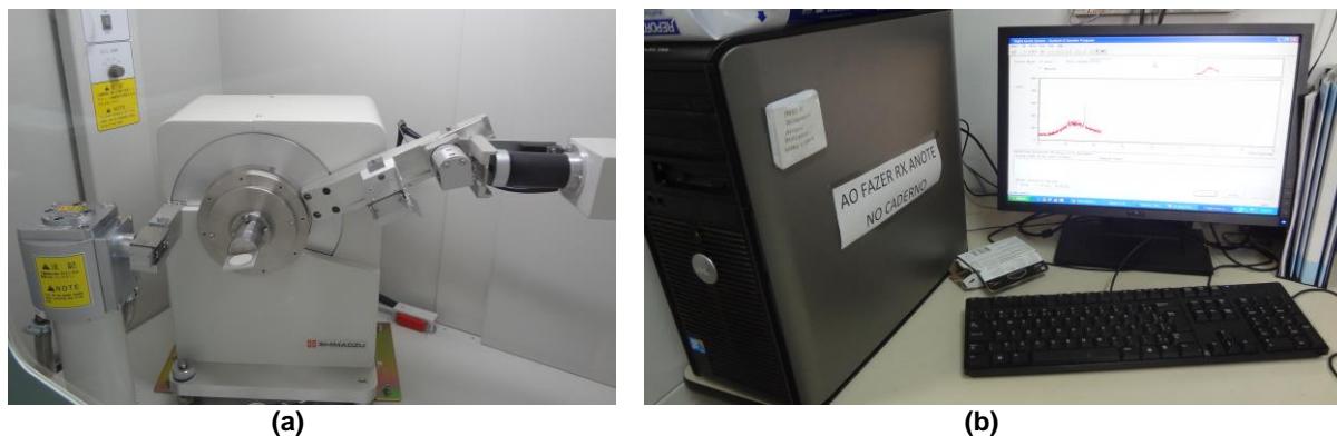
Figura 31: Ensaio de difração de raios X - (a) difratômetro e (b) computador com software.
