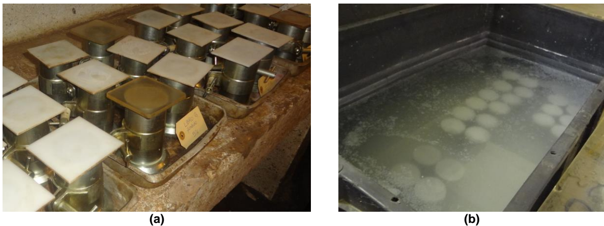
Figura 39: Preparação dos corpos de prova (a) 24 horas em câmara úmida e (b) cura imersa.
