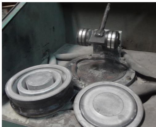
Figura 68: Moinho de argolas utilizado na moagem dos resíduos após fusão.
