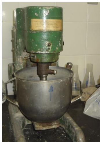
Figura 37: Misturador planetário utilizado para produção das argamassas.
