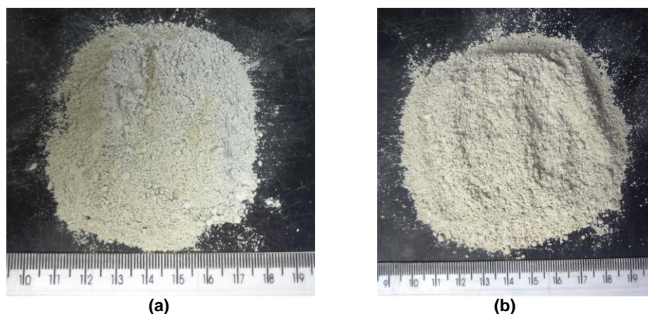
Figura 45: Resíduos utilizados na pesquisa (a) LBRO G e (b) LBRO D – condição TT0.
