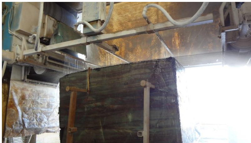
Figura 9: Tear multifios iniciando o processo de corte.
