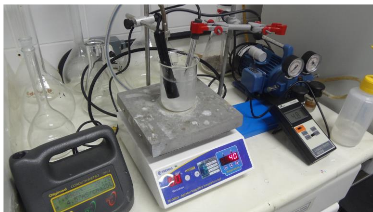
Figura 36: Aparato experimental para o ensaio de pozolanidade pelo método de Lúxan.
