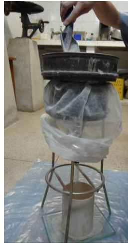
Figura 29: Ensaio de massa unitária do resíduo.
