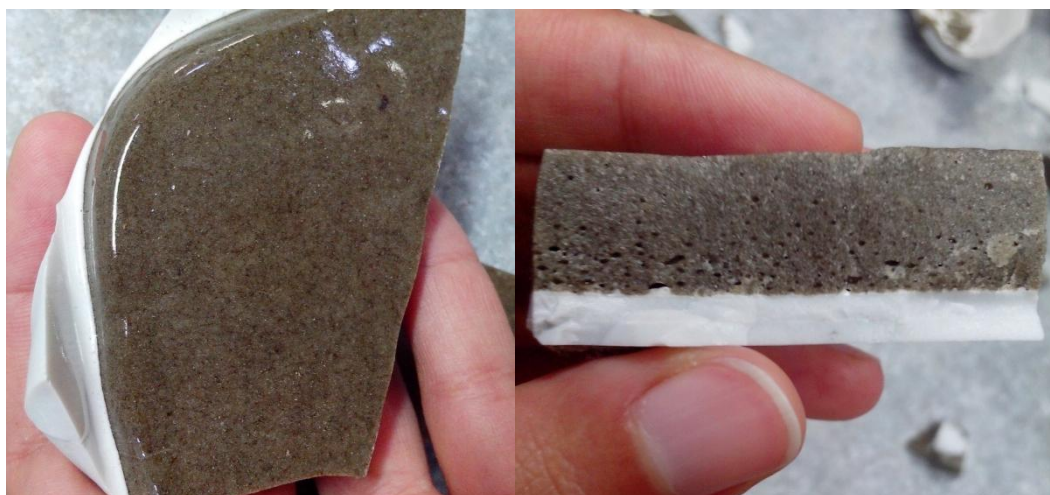
Figura 32 - Aspecto vítreo do RBRO após tratamento térmico a 1.200 °C
