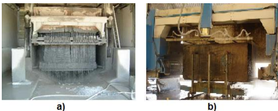
Figura 14 - Teares utilizados no corte de blocos de rochas ornamentais: a) tear tradicional; b) tear de fio diamantado
