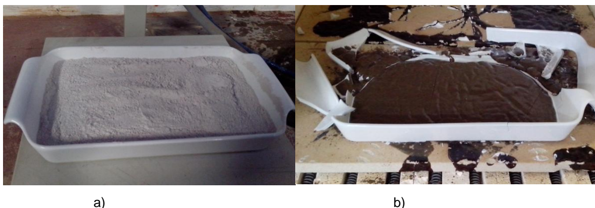
Figura 31 - a) RBRO destorroado antes de aquecido e b) RBRO após tratamento térmico a 1.200 °C
