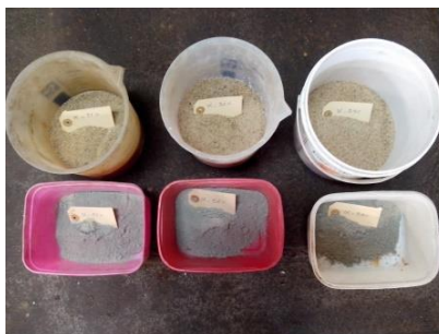
Figura 51 – Cimento CPV ARI e agregado miúdo pesados e separados para a dosagem do concreto.
