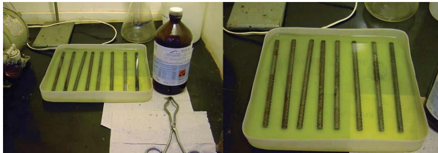
Figura 49 - Limpeza das barras de aço em solução de ácido clorídrico na concentração de 1:1 e 3,5 g de hexametilenotetramina, por um período de 15 minutos
