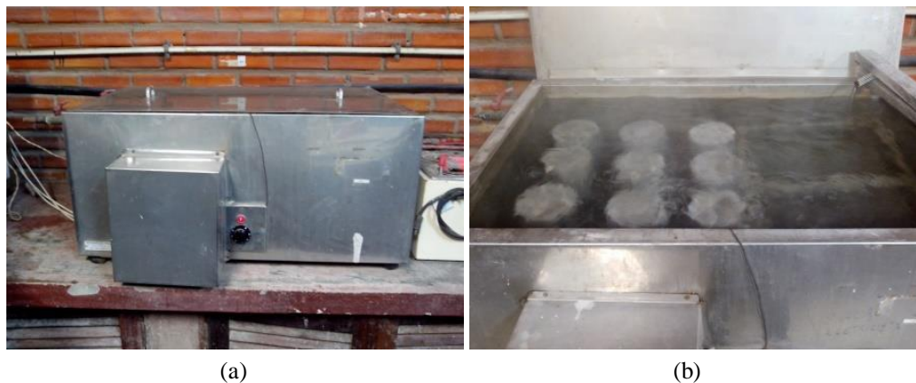
Figura 54 – (a) Recipiente para manter a ebulição e (b) corpos de prova durante o processo de ebulição.
