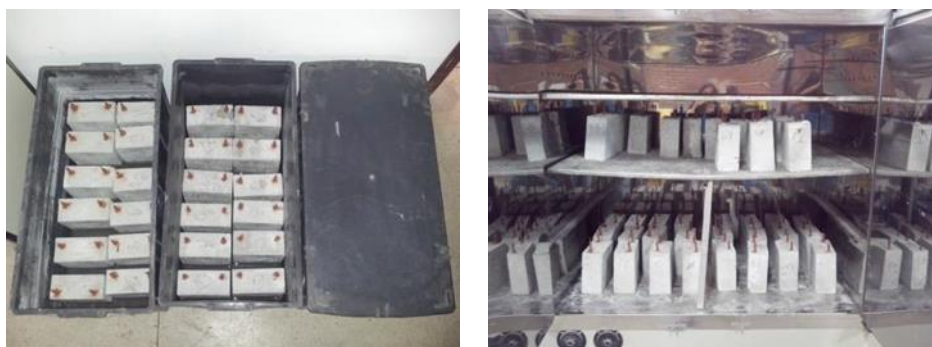
Figura 56 – Indução e aceleração da corrosão: (a) corpos de prova em imersão em solução rica em cloretos e (b) secagem em estufa ventilada.
