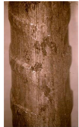
Figura 85 – Fotografias das barras após ciclos de indução e aceleração da corrosão
