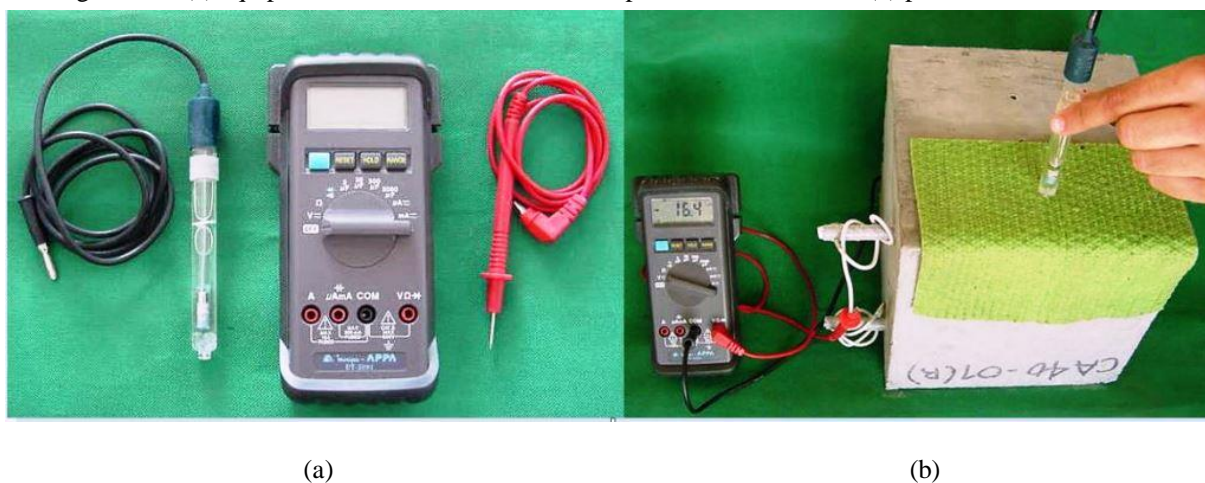
Figura 57 – (a) equipamentos utilizados no ensaio de potencial de corrosão; (b) procedimento do ensaio.
