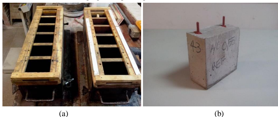
Figura 34 –(a) Forma em madeira para a moldagem de corpos de prova prismáticos, (b) corpo de prova após desforma, preparado para o processo de cura submersa.
