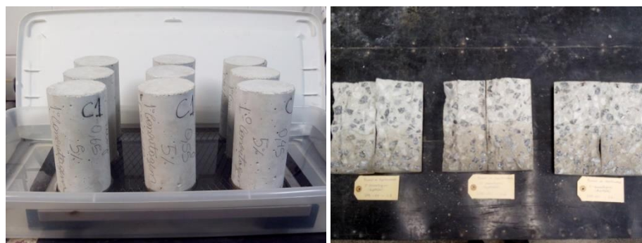
Figura 55 – (a) Corpos de prova em recipiente munido de suporte o qual garante o nível d'água de 5 \pm 1 mm acima de sua base; (b) corpos de prova após rompimento por compressão diametral.
