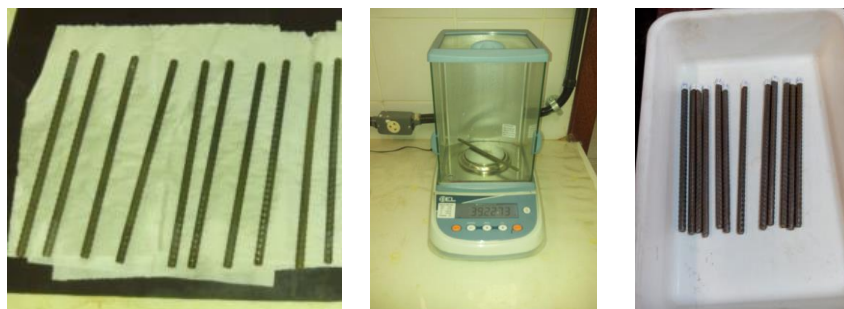
Figura 50 – (a) Barras após secagem com jato de ar quente, (b) aferição das massas em balança de alta precisão e (c) barras identificadas.
