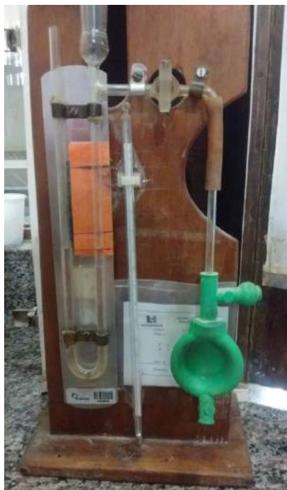
Figura 33: Equipamento utilizado para determinação da finura pelo método de Blaine
