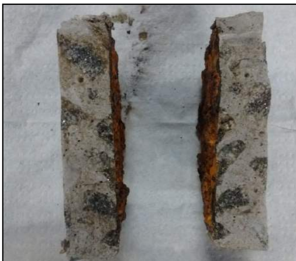
Figura 46: Corpo de prova após aspensão de nitrato de prata
