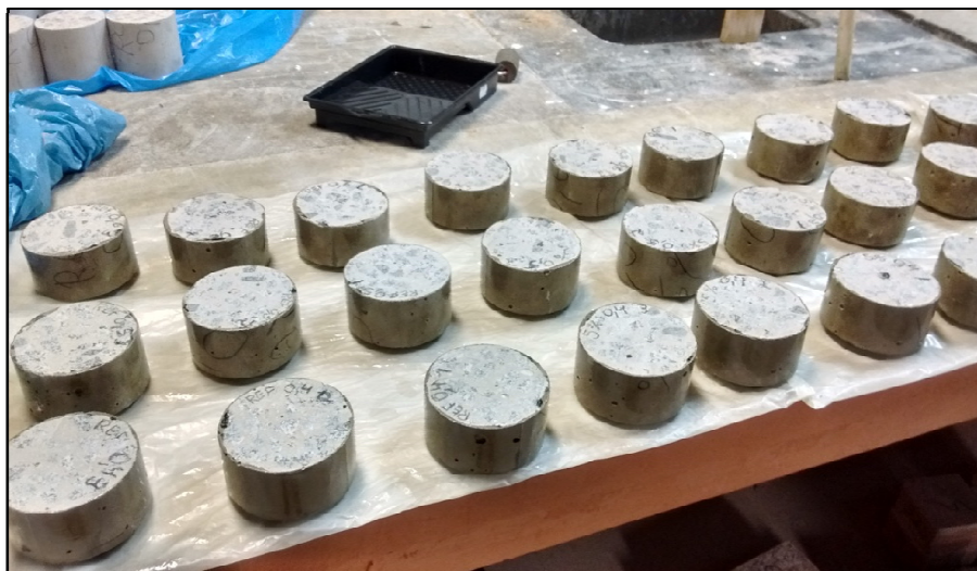
Figura 48: Corpos de prova com as laterais seladas
