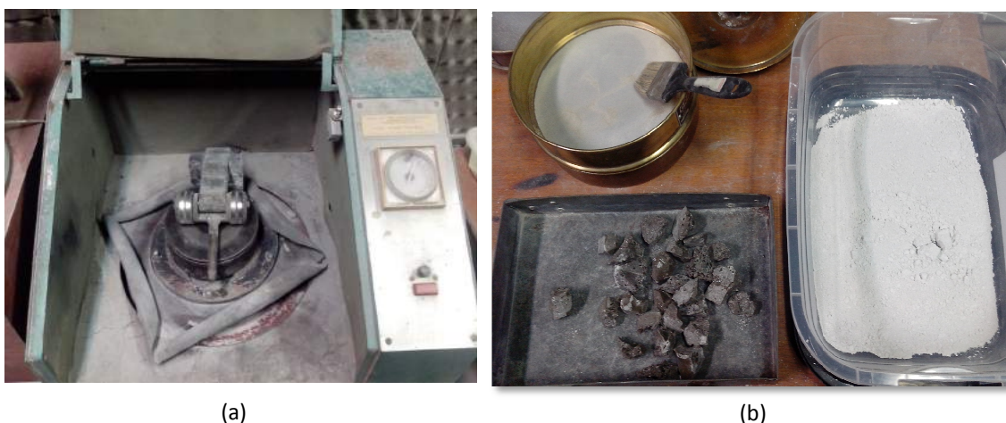
Figura 28: Processo de moagem (a) moinho de argolas (b) RBROTT após a moagem
