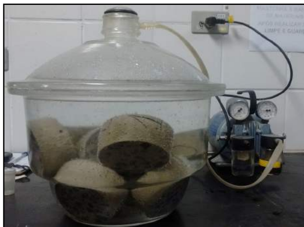
Figura 49: Corpos de prova em processo de saturação
