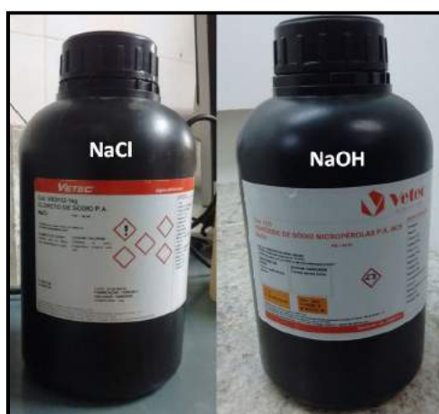
Figura 47: Cloreto de sódio e Hidróxido de sódio utilizados no ensaio segundo a ASTM C1202-12
