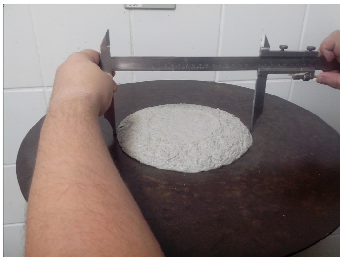
Figura 35: Ensaio de índice de consistência
