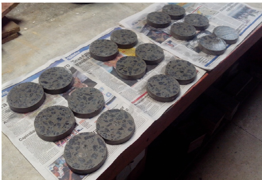
Figura 40: Corpos de prova para ensaio de migração de cloretos – UNE 83987 (UNE, 2014)
