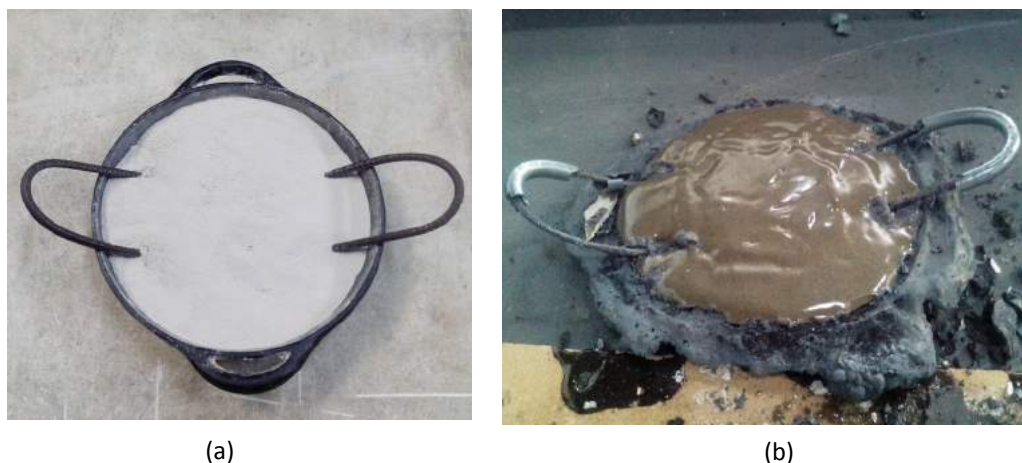
Figura 25: Recipiente contendo o resíduo (a) antes do tratamento térmico (b) depois do tratamento
