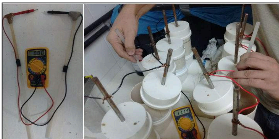
Figura 44: Procedimento para leitura da tensão
