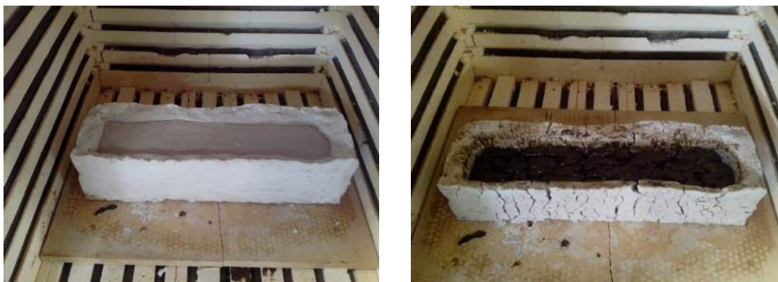
Figura 26: Recipiente de gesso com o resíduo (a) antes do tratamento térmico (b) depois do tratamento
