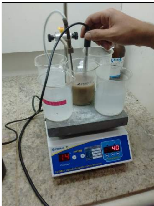
Figura 34: Ensaio de pozolanicidade pelo método de Luxán
