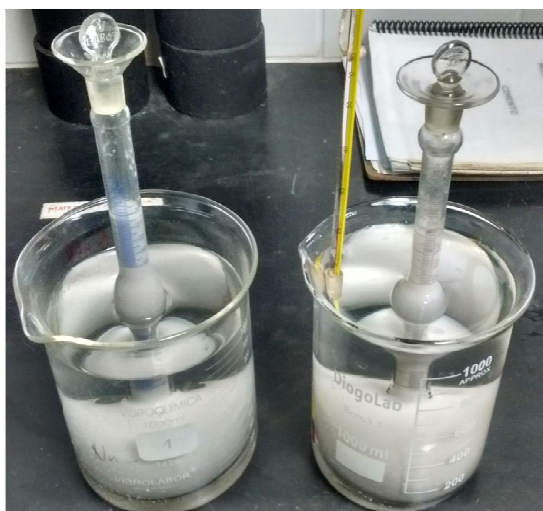
Figura 31: Ensaio de massa específica do RBROTT
