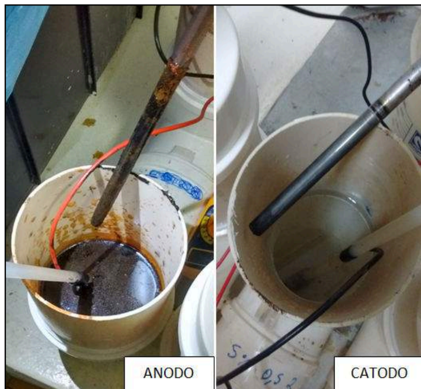
Figura 45: Corrosão anodo e catodo
