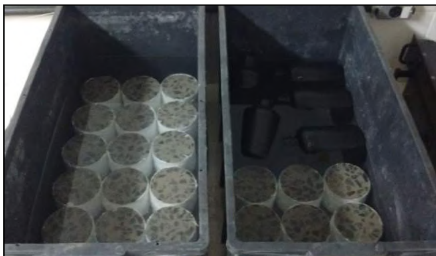
Figura 53: Corpos de prova imersos em solução salina
