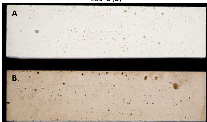
Figura 8: Corpos de provas da argamassa referência (A) e argamassa contendo adição de RBRO tratado a 900°C (B)
