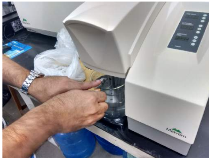
Figura 30: Aparelho para ensaio de granulometria a laser
