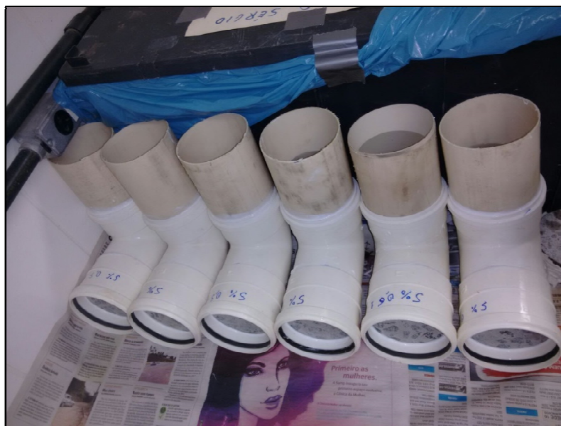
Figura 41: Teste de estanqueidade
