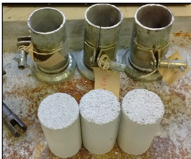
Figura 36: Corpos de prova para determinação do IAP-CAL
