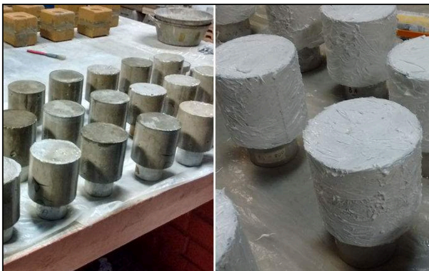
Figura 52: Corpos de prova impermeabilizados
