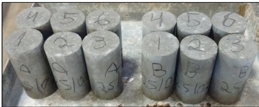
Figura 37: Corpos de prova de argamassa para avaliação do IAP
